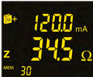
Paso 1: impedancia y corriente de fuga
