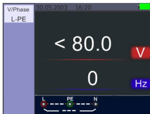
Standby Anzeige der Spannungsmessung (< 80V)
