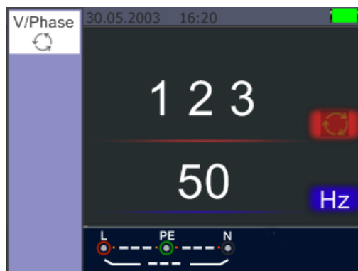
Richtige Phasensequenz L1, L2, L3 (rechtsdrehendes Drehfeld)
