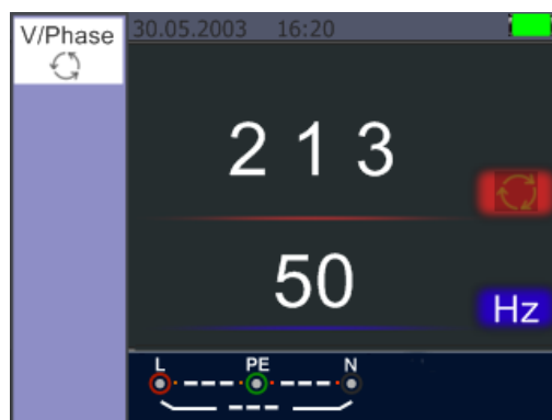
Zwei Phasen vertauscht (linksdrehendes Drehfeld)
